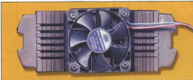
Foto 1 - Ventola e dissipatore integrato tipo CPU per computer.
