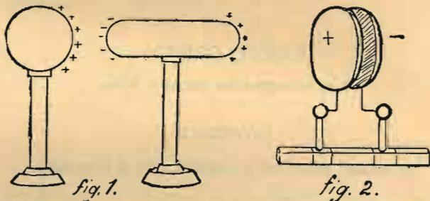
mula si estende a tutti i sistemi di conduttori, bastando, per trovare la capacità di uno di essi, fare la divisione della sua carica elettrica per il suo potenziale.
