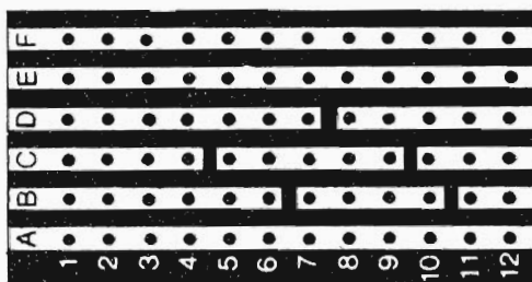
Fig. 13.5 - Frammento di piastra Uniprint, 35 x 67 mm., per il montaggio dell'unità « serratura » captatrice.
