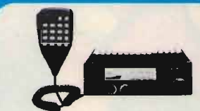
FT2400H - RxTx semiprofessionale, 50W RF e tono 1750 Hz
