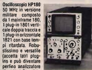
Oscilloscopio HP180 50 MHz in versione militare composto da 1 mainframe 180, 1 plug-in 1801 verticale doppia traccia e 1 plug-in orizzontale 1821 con base tempi ritardata. Robustissimo e versatile (accetta altri plug-ins e può diventare perfino analizzatore di spettro). Completo di sonda originale HP, manuali e contenitore metallico. Come nuovo L. 630.000 trasporto escluso.
