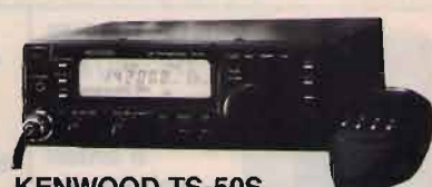
KENWOOD TS-50S Il più piccolo RTX HF All mode 50 kHz-30 MHz - Shift IF incorporato
