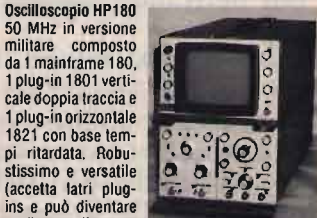
Oscilloscopio HP180 50 MHz in versione militare composto da 1 mainframe 180, 1 plug-in 1801 verticale doppia traccia e 1 plug-in orizzontale 1821 con base tempi ritardata. Robustissimo e versatile (accetta altri plug-ins e può diventare perfino analizzatore di spettro). Completo di sonda originale HP, manuali e contenitore metallico. Come nuovo L. 630.000 trasporto escluso.
