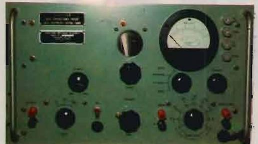
SPECTROM ANALYZER TS 723 D/U - Strumento per misurare la banda passante su segnali radio in BF.
