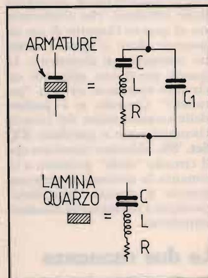
① Circuito elettrico equivalente di un quarzo. A sinistra, una lamina di quarzo corrisponde ad un circuito risonante "serie" ad altissimo Q. A destra, il circuito equivalente quando la lamina di quarzo è montata fra due armature che introducono la capacità C1. In questa situazione abbiamo un circuito risonante "parallelo".
