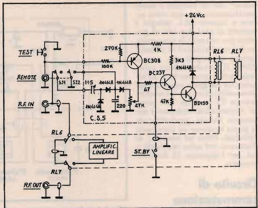
③ C.S.5.: Circuito Commutatore d'antenna.
