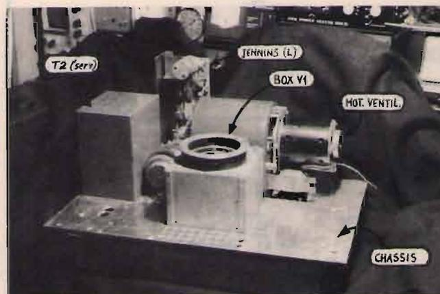
⑥ "Assemblaggio dei componenti sullo chassis: si monta il trasformatore dei servizi T2, il jennings col suo servomotore (di Load), il box V1 e il sistema di ventilazione forzata".
