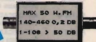
Ottimo filtro anti disturbo per ricetrasmittitori 144 e 430 MHz ideale per eliminare fenomeni di interferenza con la banda 88/108 potenza massima 50 Watt.
