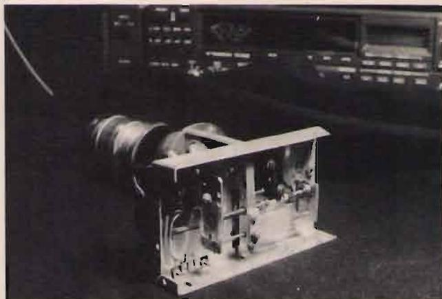
④ "Meccanica del Jennings Plate: si noti il perno filettato che funge da vite senza fine e gli Switch di fine corsa".
