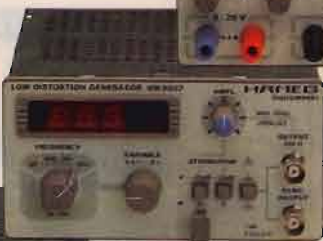
HM 8037. Generatore a bassa distorsione 5 Hz - 50 KHz Lettura digitale della frequenza
