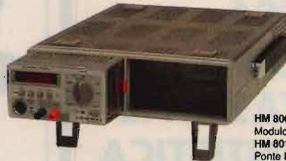
HM 8030-3. Generatore di funzioni 0,02 Hz - 2MHz Indicazione digitale della frequenza. Offset regolabile Ingresso FM Uscita del Trigger.
