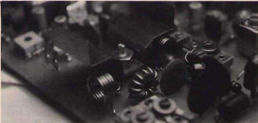
Particolari costruttivi dello stadio pilota. Si notino le bobine avvolte in aria e le impedenze avvolte su nuclei toroidali.
