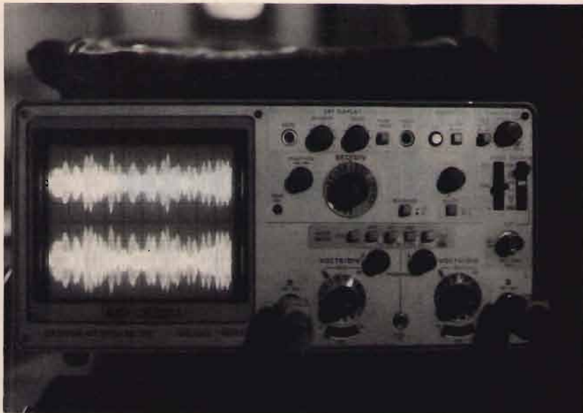
Comparazione dei segnali su oscilloscopio da 60 MHz. Il segnale in uscita dal TX (sopra) confrontato con quello in uscita dal Transverter. Come si può notare la distorzione è bassissima.
