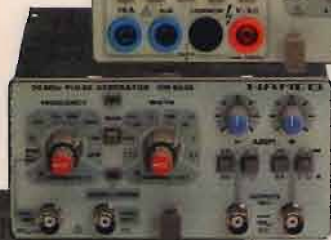
HM 8035. Generatore d'impulsi 2 Hz - 20MHz 2 uscite separate +/- Impulso singolo. Tempo di salita <3 ns.
