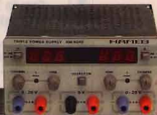
HM 8040 Alimentatore triplo 3 uscite indipendenti 2x0 - 20V; 1x5V. Indicazione digitale di tensione corrente limitatore di corrente regolabile.
