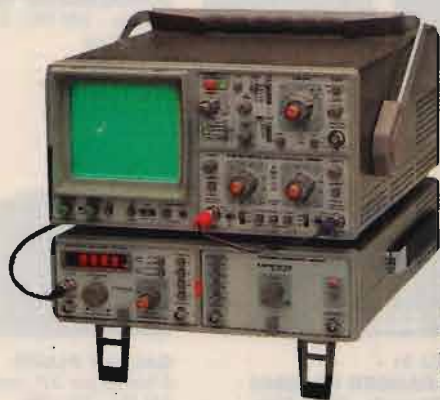
HM 604. Oscilloscopio 2 canali 60 MHz. Trigger TV con scelta 1/1° semiquadro/riga. HM 8028. Analizzatore di spettro 0.5 - 500 MHz. Livello di rumore medio - 99 dBm HM 8038. Tracking generator con uscita tra +1 dBm e 50 dBm
