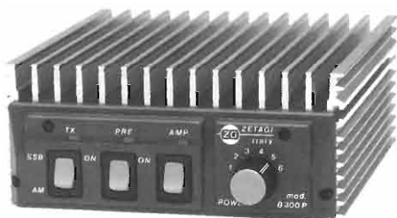
B 300 P per mobile Frequenza: 3 - 30 MHz Potenza d'ingresso: 1 - 10 W AM 20 SSB Potenza d'uscita: 70 - 200 W AM 400 SSB Preamplicatore incorporato Alimentazione: 12 - 14 V 22 A Dimensioni: 180 x 160 x 70 mm
