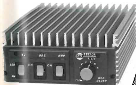
B 501 P per mobile Frequenza: 3 - 30 MHz Potenza d'ingresso: 1 - 10 W AM 20 SSB Potenza d'uscita: 70 - 300 W AM 500 SSB Preamplicatore incorporato Alimentazione: 24 - 28 V 24 A Dimensioni: 260 x 160 x 70 mm
