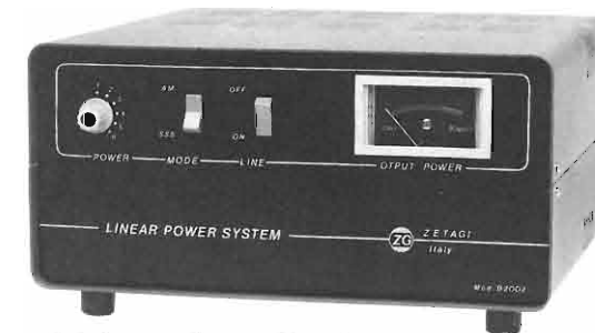
B 2002 per base fissa Frequenza: 20 - 30 MHz Potenza d'ingresso: 1 - 10 W AM 20 SSB Potenza d'uscita: 80 - 600 W AM 1200 SSB Alimentazione: 220 V 50 Hz Dimensioni: 310 x 310 x 150 mm
