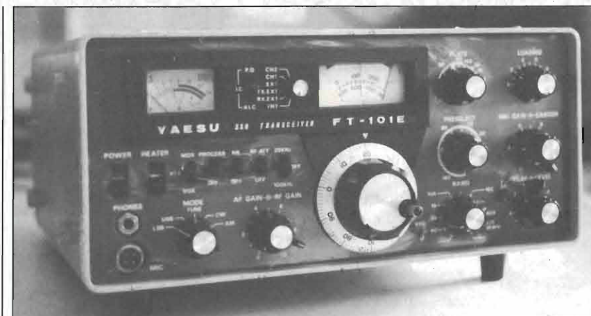
foto 11 Uno dei più "giovani" del surplus: lo FT-101E della YAESU, ancora presente in tante Stazioni. Lo FT-101E è il capostipite delle famiglie dei nuovi RX/TX transistorizzati, con finale a valvole, alimentabile anche a 12 V.
