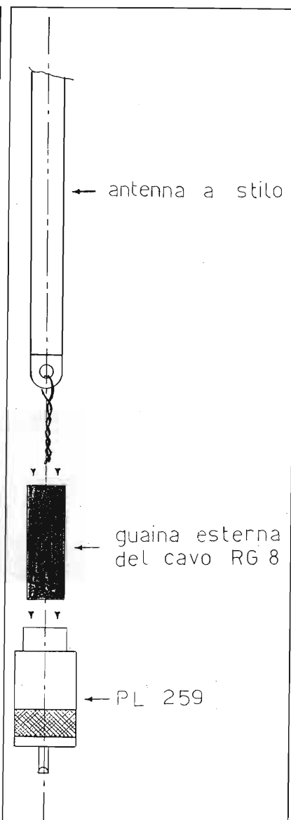
figura 1 Schema di montaggio della antenna per scanner.
