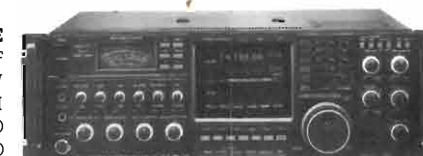
ICOM IC 781E RICETRASMETTITTORE HF 0-30 MHz - 100 W TUTTI I MODI ANALIZZATORE DI SPETTRO INCORPORATO
