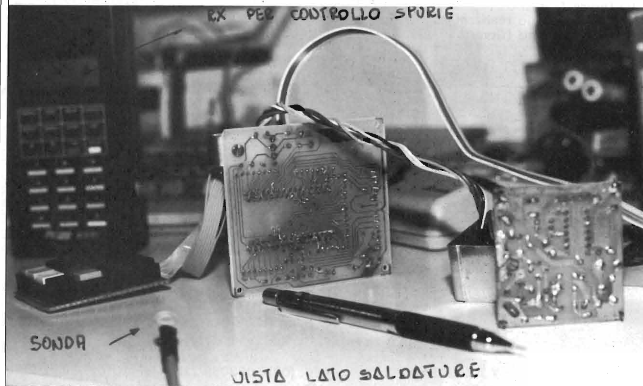
foto 5 Le basette del VCO-PLL (a destra) e della CPU (al centro) viste dal lato rame. In primo piano, la sonda-spira.
