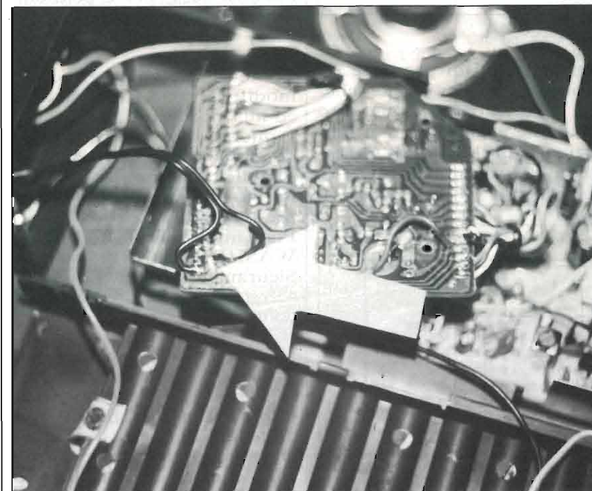
foto 2 Pista da interrompere sul PRO 2000.
