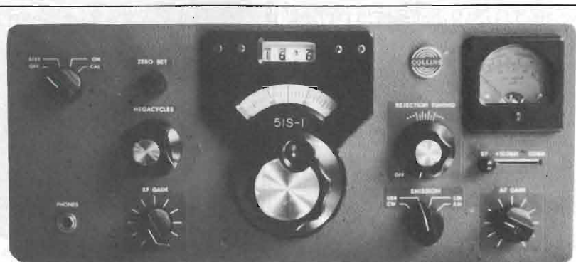
foto 1 Il Collins 51S-1, ricevitore a sintonia continua da 0 a 30 MHz.
