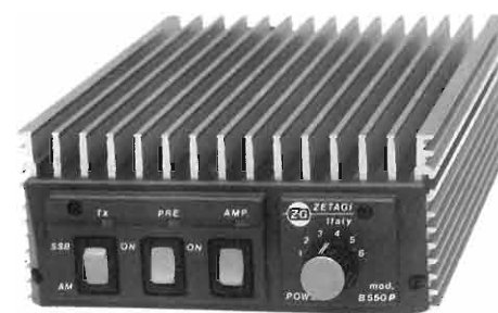
B 550 P per mobile Frequenza: 3 - 30 MHz Potenza d'ingresso: 1 - 10 W AM 20 SSB Potenza d'uscita: 70 - 250 W AM 500 SSB Preamplificatore incorporato Alimentazione: 12 - 14 V 35 A Dimensioni: 260 x 160 x 70 mm
