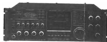
ICOM IC 781 ricetrasmittitore multimodo HF, 150 W pep
