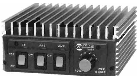
B 300 P per mobile Frequenza: 3 - 30 MHz Potenza d'ingresso: 1 - 10 W AM 20 SSB Potenza d'uscita: 70 - 200 W AM 400 SSB Preamplificatore incorporato Alimentazione: 12 - 14 V 22 A Dimensioni: 180 x 160 x 70 mm
