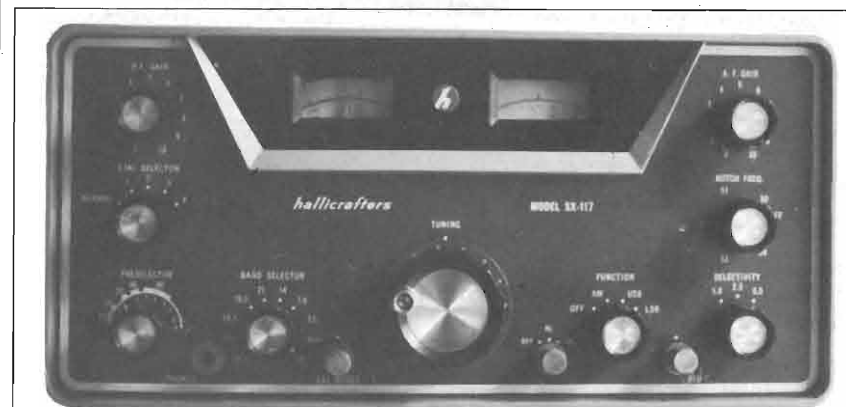
foto 7 Sempre in tema di ricevitori: Hallicrafters SX-117, a tre conversioni di frequenza.
