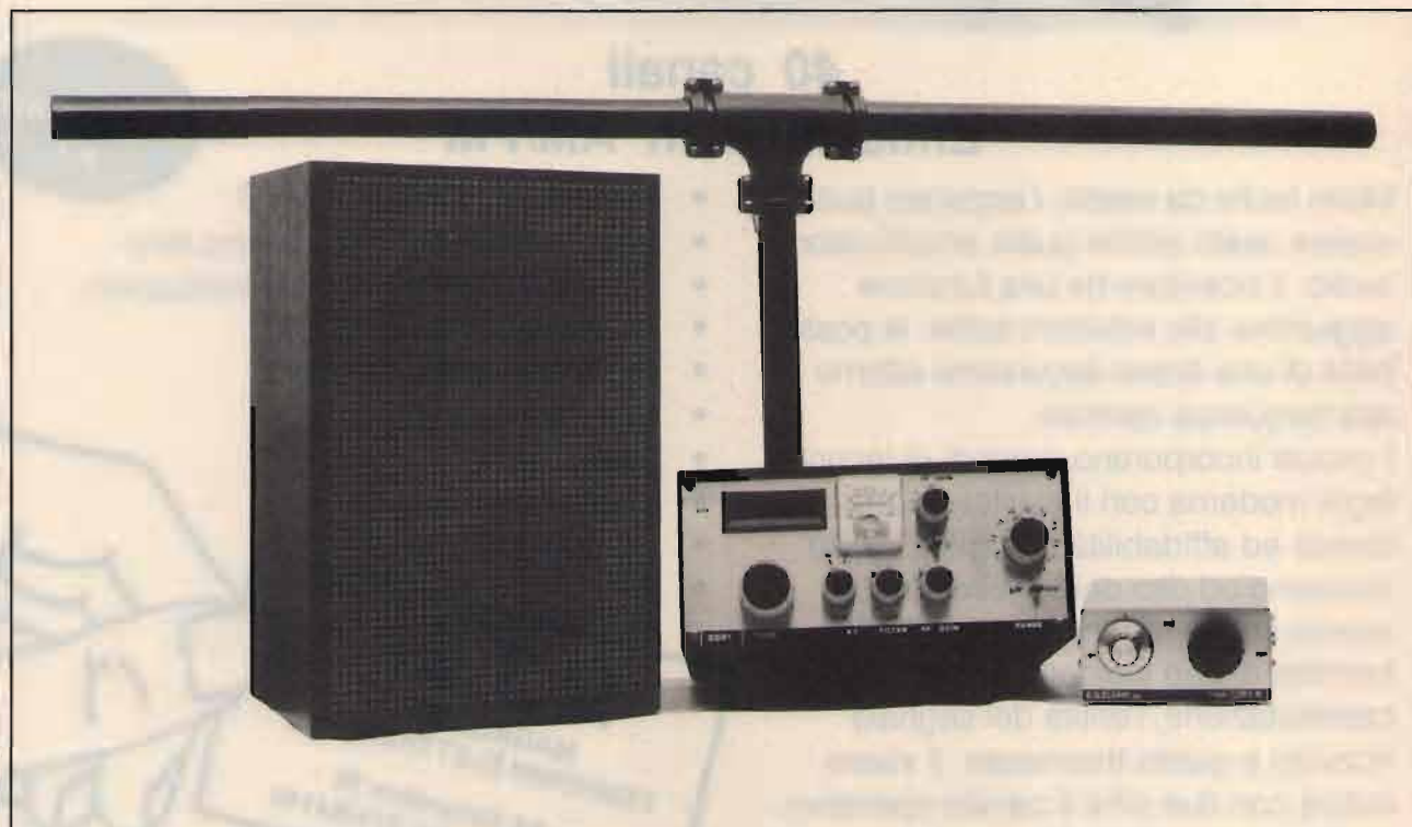
Sistema completo del ricevitore sincrodina per onde lunghe e medie: la control box di comando dell'antenna attiva in ferrite LPF1R; il ricevitore sincrodina "SDR1" e la cassa acustica di tipo attivo utilizzata quale amplificatore di potenza in bassa frequenza che permette di apprezzare totalmente la qualità di riproduzione audio del demodulatore sincrono. Sul fondo domina l'elemento ricevente dell'antenna LPF1R (110 cm), la cui funzione è duplice: sistema ricevente, e di preselezione del segnale ricevuto.
