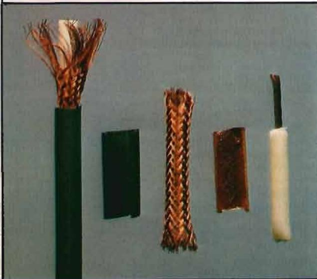
A BASSA PERDITA PER VHF/UHF • MISURE ESATTE DEL RG213 PER CONNETTORI «PL-N» e «BNC» • FORMAZIONE CC 7x0,75 • DIELETTRICO FOAM (ESPANSO) • FOGLIA DI RAME 6 DECIMI CON GUAINA ANTIMIGRANTE INCORPORATA • CALZA DI RAME NORME MIL • GUAINA VERDE «ECOLOGICA» IN POLITENE Ø 10,30
