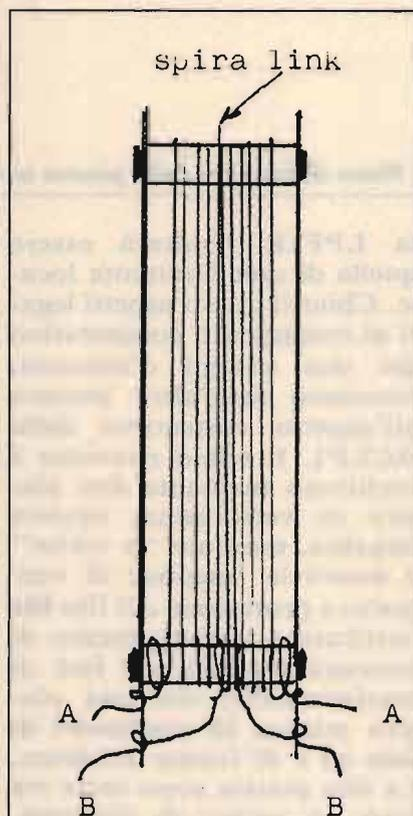
I capi terminali dell'avvolgimento di sintonia e del link vanno infilati nei rispettivi fori  $\varnothing$  1,5 mm di ciascuna piastra e attorcigliati come indicato nel disegno. La spirale del link va avvolta esattamente a metà dell'avvolgimento di sintonia. A = terminali dell'avvolgimento di sintonia. B = terminali dell'avvolgimento link.
