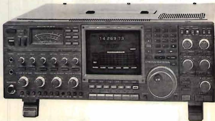
**IC-781 Ricetrans HF, sintonia continua - con monitor centrale per il controllo di frequenza e di bande**
