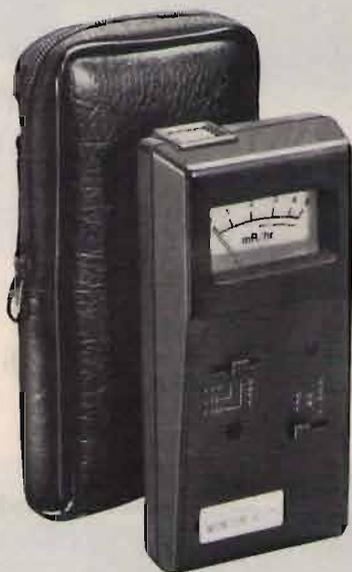
Piccolo, pratico contatore Geiger tascabile per il controllo di elementi radioattivi sospetti e cioè i noti raggi alfa, beta, gamma ed altri isotopi non così conosciuti. Esso ha una precisione sufficiente per avvertire che esistono bassi livelli di radiazione, anche a livello innocuo, e può avvertire quando essi superano la soglia di allarme.
