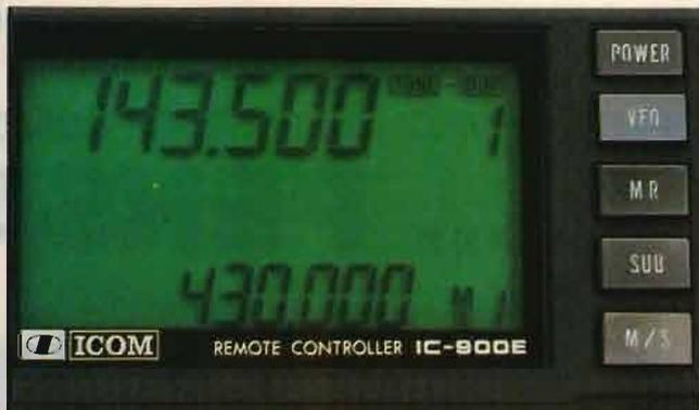
**Dal display sul cruscotto puoi pilotare un transceiver dalle HF alle UHF**
