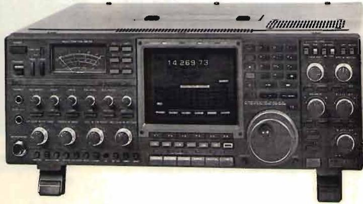
**IC-781 Ricetrans HF, sintonia continua - con monitor centrale per il controllo di frequenza di bande**
