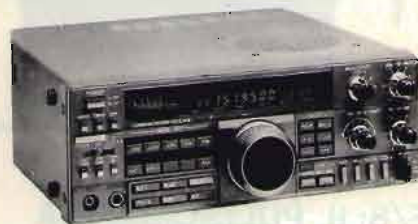
TS 440 S Ricetrasmittitore HF - Copertura continua AM-FM-CW-SSB 220 W P.e.P.
