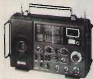
MARC NR-82 F1 Ricevitore portatile transoceanico, multibanda: 150 kHz-30 MHz; 30 MHz-470 MHz. Suddivisi in 12 bande, AM-FM-USB-LSB con BFO. Alimentazione 220 Vac o batterie. Corredato di 3 antenne. Lettore di frequenza digitale.
