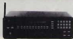
JD SX 400 Ricevitore con dispositivo di ricerca entro lo spettro da 28 MHz / 550 MHz, copertura continua, AM, FM, 20 canali memorizzabili, per espansione, 3 convertitori optional: da 550 a 800 MHz; da 800 a 1400 MHz; da 1400 MHz a 3,7 GHz. Strumento di controllo-S meter - attenuatori.
