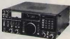
ICOM ICR 71 Ricevitore a copertura generale da 100 kHz / 30 MHz FM, AM, LSB, USB, CW, RTTY, 4 conversioni con regolazione della banda passante, 3 conversioni in FM, sintetizzatore di voce optional, 32 memorie a scansione.
