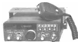
YAESU FT 780 R Ricetrasmittitore UHF 430/440 MHz con memorie, potenza uscita RF 15 W PeP, emissione FM, LSB, USB, CW, alimentazione 13,8 Vdc, scansione automatica, sull'apparato e microfono.
