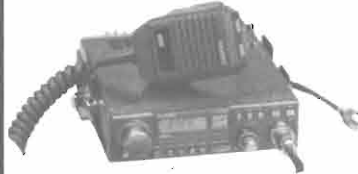
YAESU FT 270 RH Ricetrasmittitore portatile FM 144/146 MHz o 144/148 MHz, potenza 45 W, nuovo tipo di supporto ad aggancio rapido.
