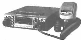
ICOM IC 27 E-H Ricetrasmittitore VHF veicolare, per emissioni FM, 144/146 MHz, 9 memorie, 32 frequenze sub audio, potenza RF 5 W, alimentazione 13,8 Vcc.
