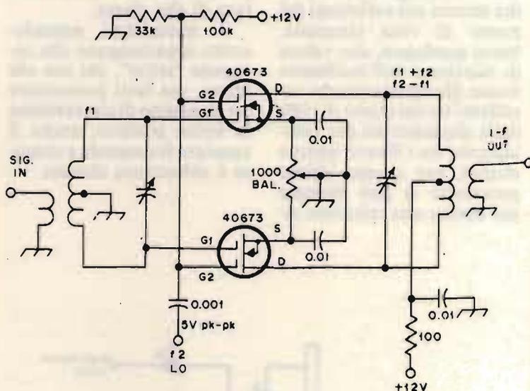
dei due, durante le operazioni di montaggio dovesse bruciarsi, non ci si accorgerebbe del guaio se non con misure appropriate, in pratica il mixer funzionerebbe ugualmente ma non con caratteristiche di bilanciato.
