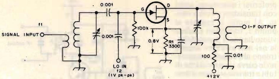
Altro mixer a fet, caratteristiche simili al precedente, necessita di una tensione di iniezione molto bassa, appena 1 V da picco a picco, buona dinamica, alto guadagno (anche 10 dB), presenta lo svantaggio di non avere reiezione fra input segnale e input oscillatore in quanto entrambi vengono applicati al medesimo elettrodo (gate), non molto adatto a stadi di ingresso se non con preamplificatore frapposto.
