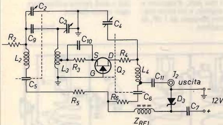
Poi allo statore di  $C_3$  da 11 pF; il circuito a questo punto ripete la precedente configurazione con  $L_3$  uguale a  $L_1$ , con presa a 1 spira e 3/4, con  $R_3$  e  $C_{10}$ ,  $Q_2$  e  $R_4$  da 10  $\Omega$  come  $R_2$ .
