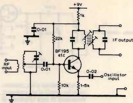
una impedenza piuttosto bassa per non alterare l'amplificazione in frequenza intermedia, sono richiesti segnali piuttosto forti per l'iniezione, di solito occorrono almeno 5 V da picco a picco.
