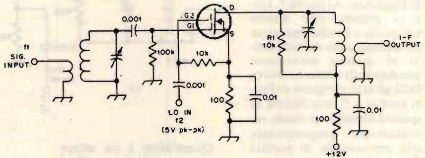
Mixer a mosfet, caratteristiche simili al precedente, necessita di tensione più alta come iniezione di oscillatore, 5 V picco-picco, essendo l'iniezione posta sul gate 2 si hanno tutti i vantaggi del precedente a fet senza avere problemi di reiezione fra input segnale e input oscillatore in condizioni ottimali il guadagno può raggiungere anche i 17 dB.
