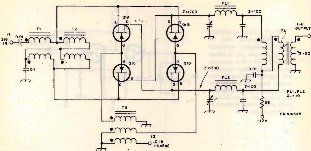
Mixer a doppio bilanciamento impiegante fet, uno dei mixers più sofisticati dal punto di vista circuitale, basso guadagno, alto valore di iniezione dell'oscillatore locale. Ha caratteristiche eccellenti sia dal punto di vista della dinamica sia per l'isolamento fra i diversi input e output, per questo ultimo parametro si può ritenere per buona una reiezione at-
