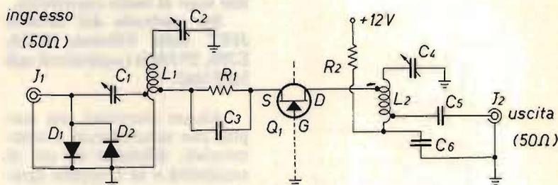
L'output viene prelevato a mezza spira verso  $R_2$ ,  $C_6$ : attenti ad effettuare un buon collegamento.
