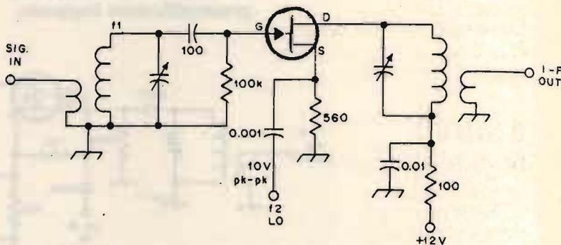
Quest'altro è un mixer con caratteristiche simili al precedente, ma utilizzando un transistor a effetto di campo (fet), necessita di una tensione di iniezione almeno doppia rispetto al bipolare nella medesima configurazione, per contro ha una dinamica più elevata ed è quindi adatto a reggere segnali input anche piuttosto elevati senza creare considerevoli prodotti di intermodulazione.
