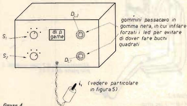
Il tutto può essere montato in una scatoletta TEKO in plastica, con i led ben visibili e  $i_1$  esterno (esempio in figura 4).
