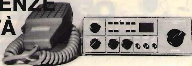
modello TIGER operante sulla nuova gamma dei 477 MHz, FM, 40 canali, 5 Watt, Simplex e duplex, compatto
