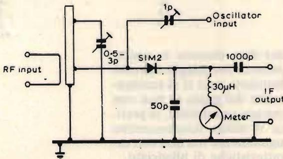
Il più semplice dei mixer a diodo; viene utilizzato di solito per la conversione di onde centimetriche, si ottimizza il punto di lavoro facendo fluire una corrente di almeno 300 µA, per questa ragione osserviamo nello schema un insolito "meter".
