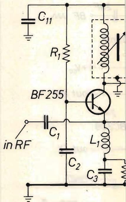
viamo il solito condensatore di disaccoppiamento ( $C_1$ ), mentre sull'emettitore del BF255 è presente un circuito accordato ( $L_1$ - $C_4$ ) alla frequenza di circa 98 MHz, che corrisponde al "centro banda" della gamma FM, che si estende tra gli 88 e i 108 MHz.
