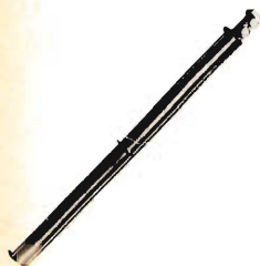
FILTRO PASSA-BASSO PROFESSIONALE COASSIALE A LARGA BANDA ATT. 2° ARMONICA 70dB PERDITA D'INSERZIONE 0,1dB. SENZA WATTMETRO POT. MAX 3 KW L. 600.000 CON WATTMETRO POT. MAX 3 KW L. 800.000
