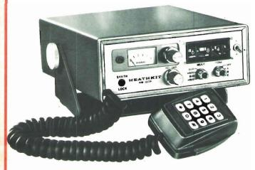
Rice-trasmettitore FM sintesizzato, con copertura di frequenza da 143,5 a 148,5 MHz.
