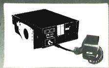
RADIOTELEFONI PORTATILI VHF per uso civile Potenza 4 Watt Canalizzazione a 25 e 12,5 KHz 1,2,12 canali
