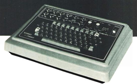
Il nuovo tetha grazie all'utilizzo di un microcomputer permette la ricezione e trasmissione automatica in CW, RTTY ed ASCII e la diretta lettura su un comune televisore domestico o monitor di segnali in anivo o in trasmissione. L'apparato è completo di modulatore demodulatore a filtri attivi dalle ottime prestazioni.
