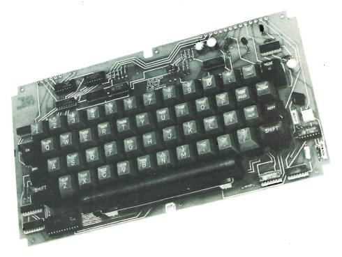
Tastiera bi-standard ASCII e BAUDOT adatta ad uso RTTY in unione al KK 112 e ad uso micro-processore in unione a KK 215. Set di 52 tasti con contatto in oro più 4 tasti di utilità (chiusura verso massa). Passaggio automatico lettere-cifre in codice BAUDOT. Uscita dati in parallelo (livello TTL) con segnale di caricamento. Alimentazione 5V. 0,5A. o 12V. con apposito regolatore (KK 213-C). Dimensioni 300 x 150 mm.
