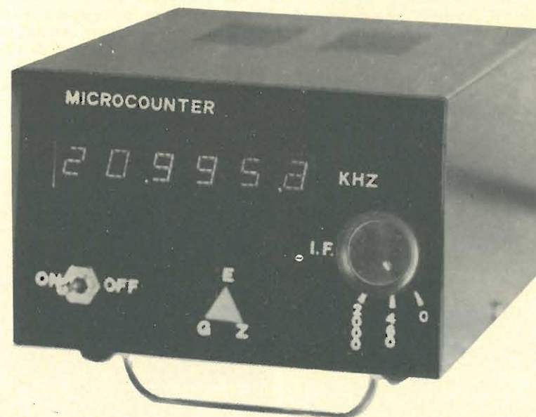
Il « MICROCOUNTER » che misura: altezza 29 mm, lunghezza 76 mm, larghezza 55 mm, praticamente un pacchetto di sigarette. La foto mostra l'apparecchio montato nel contenitore, completo di alimentatore e di detrazione della F.I. di 460 e 2.000 kHz per il Grundig Satellit.
