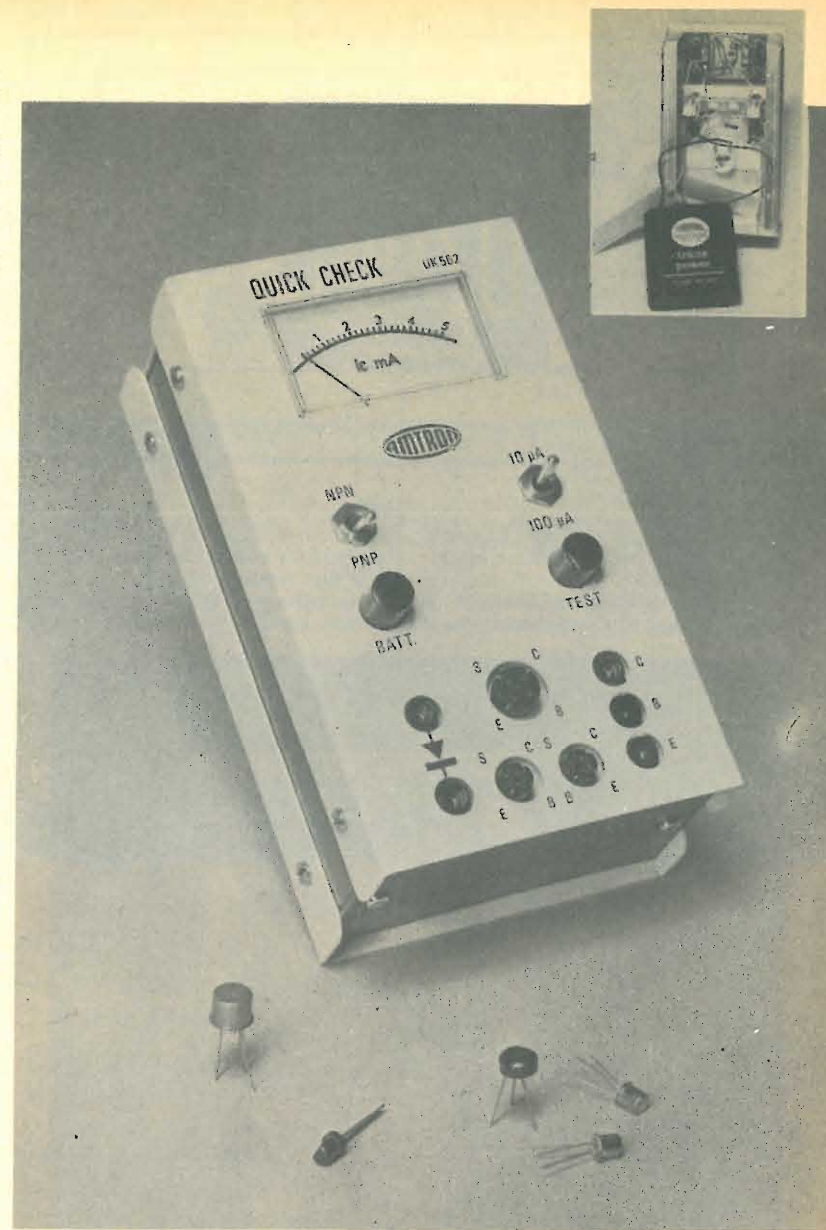
Vista in primo piano del prova transistori rapido e particolare dell'interno.
