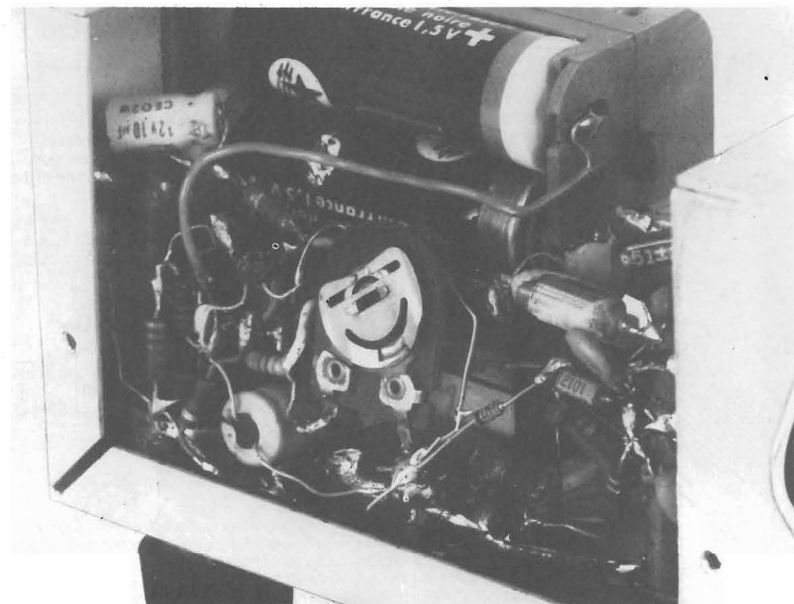
Era nato lindo, pulito, coi fili ben tesi... poi, il travaglio di una adolescenza sofferta, per prove e ricerche... C_7 , in alto a sinistra, è stato poi portato a 100 \mu F, come da schema.
