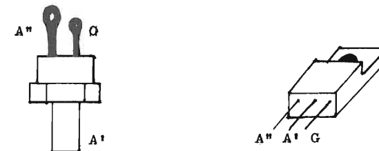
Connessioni del triac: esemplificazione per due contenitori abbastanza comuni
