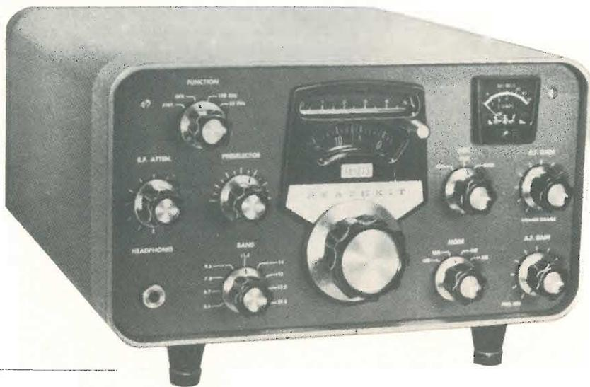
Alcune parti del ricevitore, come il delicatissimo VFO a variazione lineare di frequenza, vengono fornite montate e preterate. Gli schemi indicano le tensioni misurabili ai capi di ogni transistor. Il verniero della scala permette la lettura con l'approssimazione di 1 kHz. La sensibilità dell'apparecchio si aggira attorno ai 0,15 µV in SSB per 10 dB. La reiezione dell'immagine è di 60 ÷ 100 dB a seconda delle gamme.
