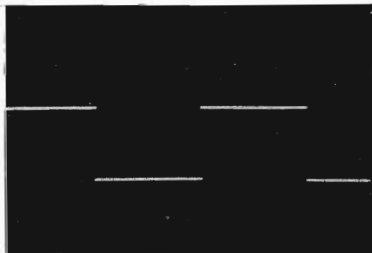
foto 2 Oscillogramma di onda quadra ottenuto con C_1 = 10 \mu F , frequenza 20 Hz, rilevata con sonda diretta e oscilloscopio predisposto con ingresso corrente continua.
