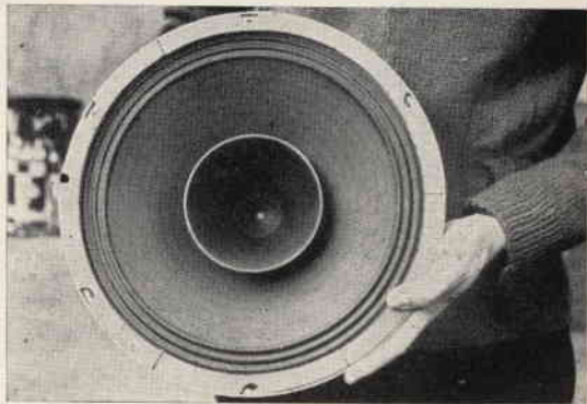
Altoparlante bicono di potenza usato nella realizzazione dell'Autore.
