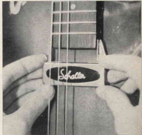
Esempio di montaggio del pick-up sulla chitarra.
