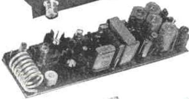
**Trasmittitore a transistori per la gamma dei 10 metri**
