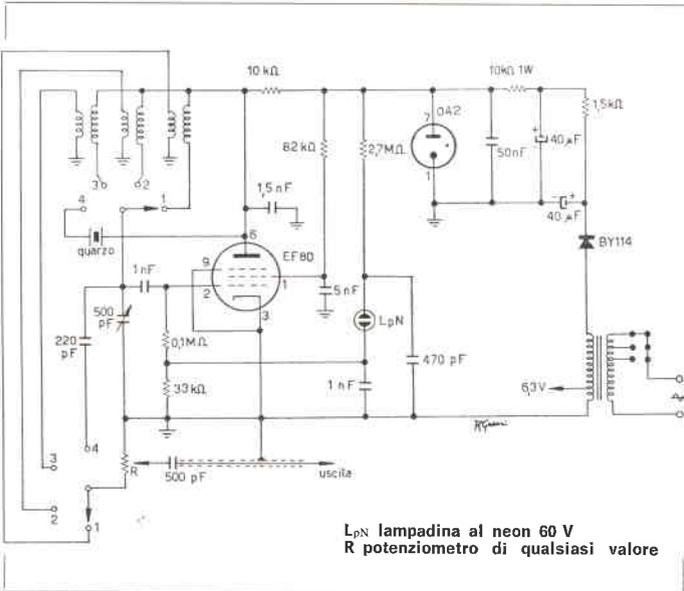
La modulazione, alquanto sommaria, è ottenuta con un oscillatore a rilassamento utilizzando un bulbetto al neon.
