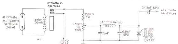
Anche su di un oscillatore a cristallo (figura 11) è in genere possibile agire, in modo da variarne la frequenza di oscillazione dello shift richiesto (850 o 170 Hz): ciò si può fare introducendo una capacità in serie al cristallo, e modificandola in maniera consistente.
