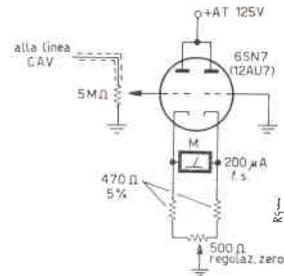
S-meter tipo voltmetro elettronico
