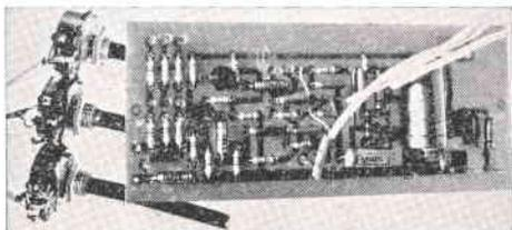
Preamplificatore/egualizzatore, per i 4 tipi di rivelatori, (magnetica RIAA - piezo - radio ad alto livello - radio a basso livello). Usa 4 transistori al silicio (3 x BC149B - 1 x BC148B). E' corredato dei controlli di tono e volume.
