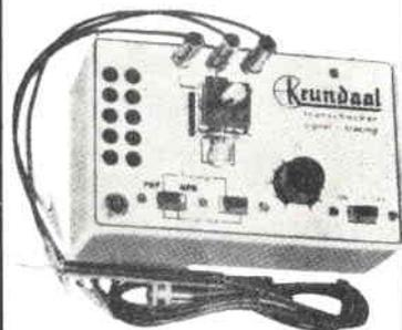
**ONDAMETRO DINAMICO GRID DIP - METER**
