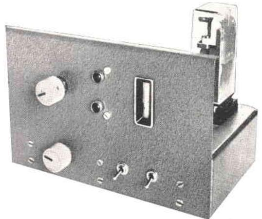
Con questo sistema di controllo vengono inviati alle placche rispettivamente orizzontali e verticali i segnali presenti ai capi dei due circuiti accordati di mark e space. L'immagine che appare perciò sullo schermo del tubo sarà un'ellisse schiacciata, verticalmente o orizzontalmente, a seconda che sia presente l'uno o l'altro dei due segnali.
