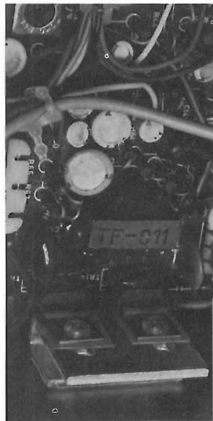
Lo stadio finale di bassa frequenza si avvale di due semiconduttori di tipo 2SC1096 collegati fra loro in push-pull. Per garantire una buona dissipazione termica, come potete riscontrare nella foto, i due transistor sono stati fissati ad un dissipatore termico direttamente connesso alla struttura in metallo del contenitore dell'apparato.
